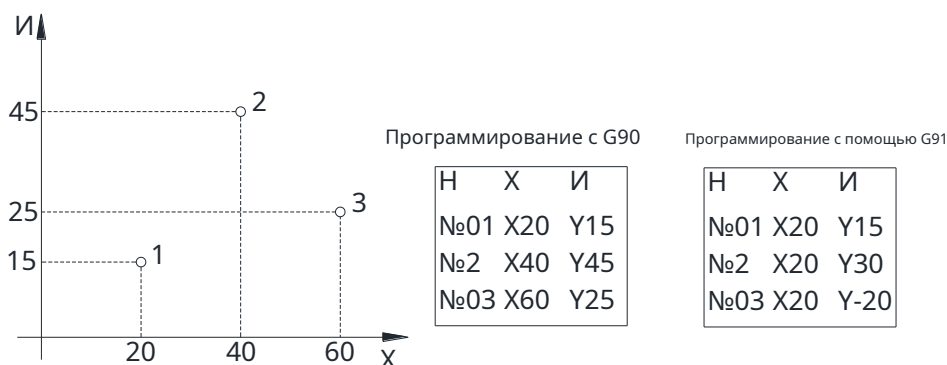
Рис. 3-1 Программирование с помощью G90/G91
